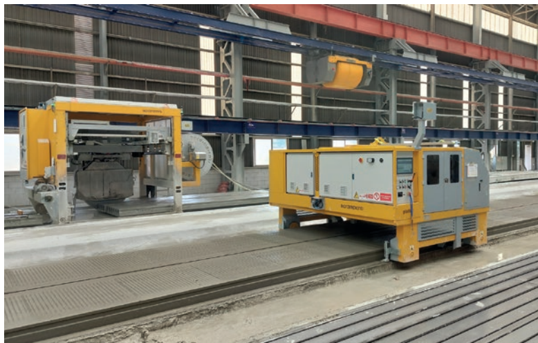
El plóter automático y la sierra multiangular funcionan de forma completamente automática
