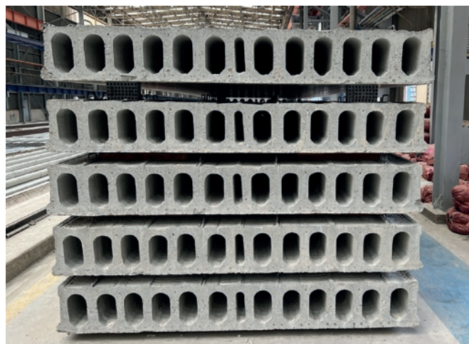
Prelosas y placas alveolares pretensadas, fabricadas con la máquina deslizante de producción local
