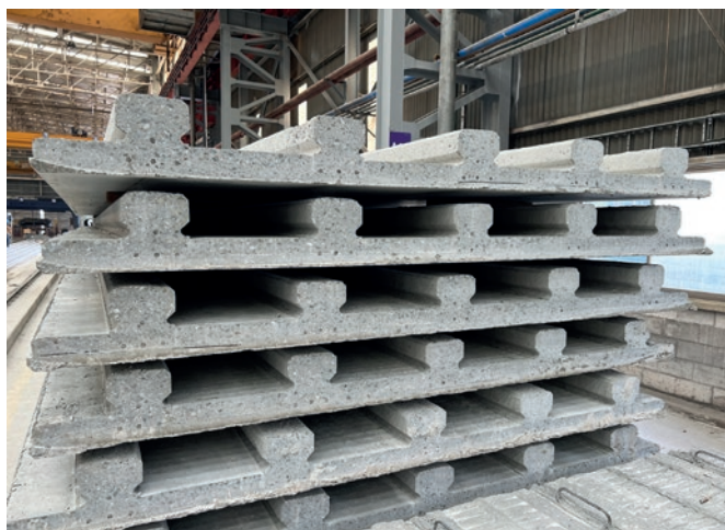
Prelosas y placas alveolares pretensadas, fabricadas con la máquina deslizante de producción local
